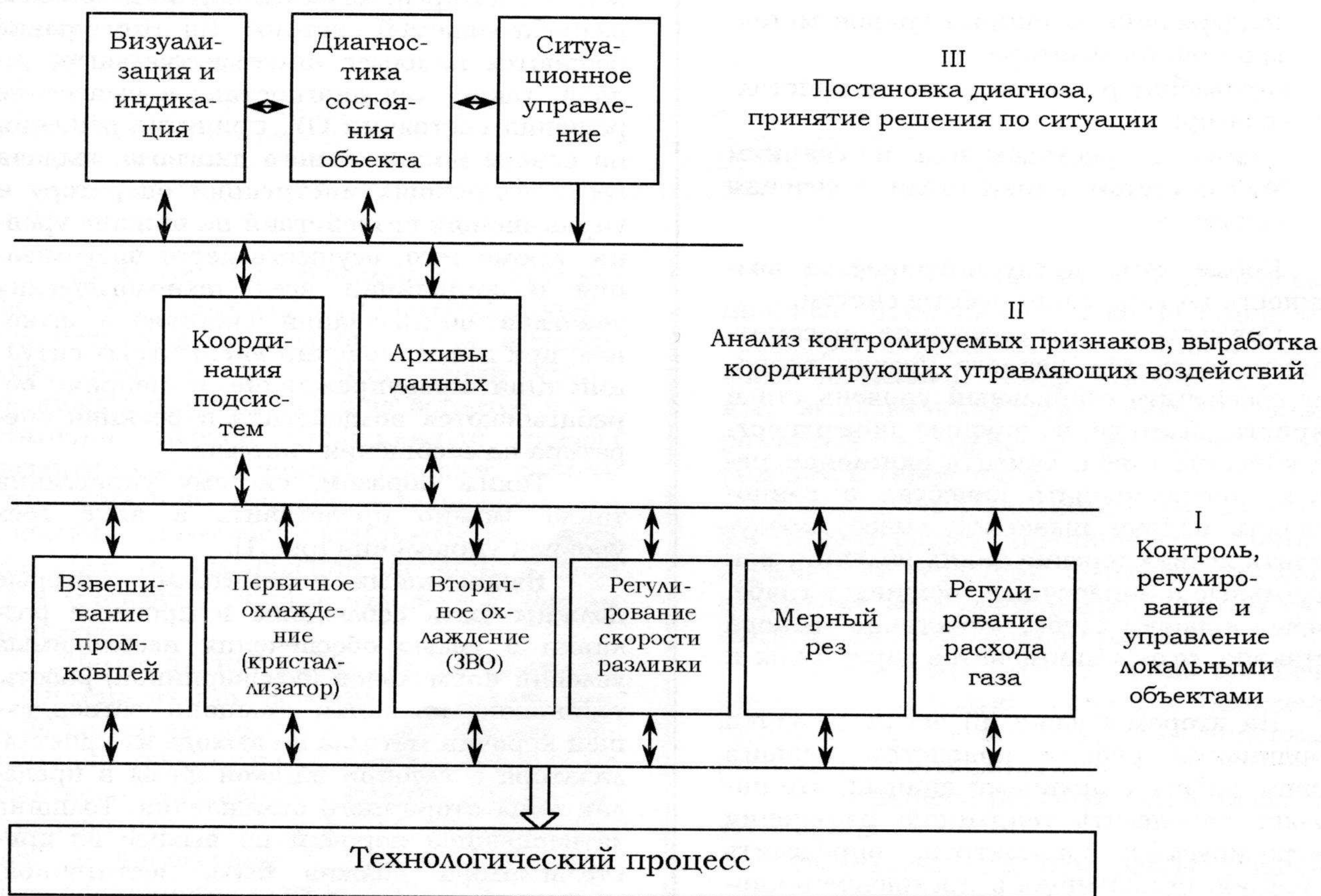
Рис. 1. Структурная схема системы управления технологическим процессом непрерывной разливки стали
