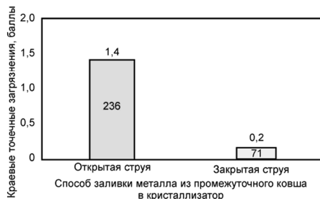
Рис. 4. Степень развития краевых точечных загрязнений в сортовой заготовке сечением 150×150 мм при разливке стали СтЗсп открытой и закрытой струей: цифры внутри столбиков — число плавков
