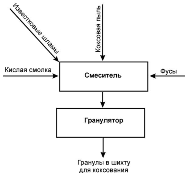
Принципиальная схема подготовки шихты из отходов КХП
