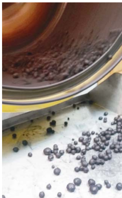
Рис. 1. Получение окатышей в лабораторных условиях
