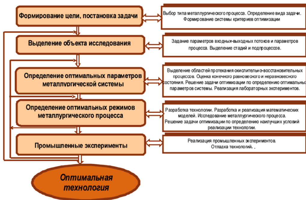
Рис. 1. Этапы, задачи и результаты метода разработки оптимальных технологических режимов металлургических процессов
